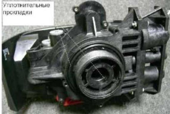
13. Аккуратно посадить блок управления с верхним защитным экраном на вертикальный коллектор, слегка нажав на блок сверху до исчезновения зазора между горловиной и нижней частью блока
