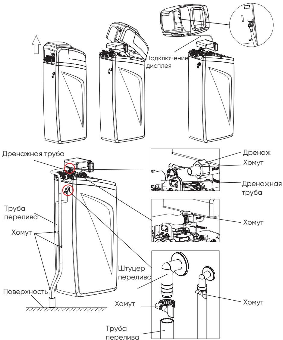
Примечание: Пожалуйста, закрепите канализационную трубу и переливную трубу с помощью кольцевого хомута. На стене, чтобы предотвратить вытекание шланга из канализационной трубы!
