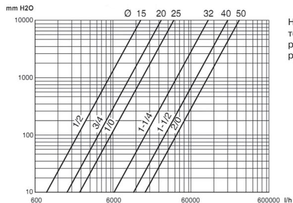
На данном графике показывается потеря давления на кране в мм H<sub>2</sub>O для разных диаметров в зависимости от расхода (л/ч).
