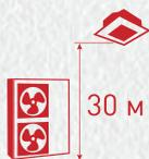
Максимальное расстояние между внутренним и наружным блоками может достигать 30 м, перепад высот — 30 м. Длины трассы и перепада высот дают широкие возможности выбора места установки сплит-системы. Расстояние между пультом и блоком может быть увеличено до 30 метров.
