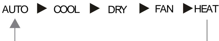
В режиме AUTO (Автоматический) установленная температура не отображается на дисплее и кондиционер будет автоматически выбирать режим работы, учитывая текущую температуру в помещении, чтобы поддерживать ее в зоне комфорта.
