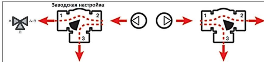
На рисунке ниже проиллюстрирован возможный способ использования клапанов для разделения потоков.
