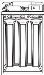
Корпус фильтра SL20 – 3 шт., корпус для мембраны типоразмером 2012 – 2 шт.
