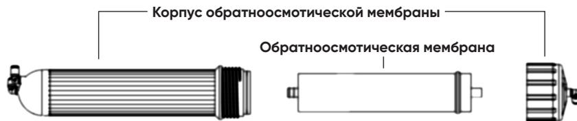
**!** При неправильной установке обратноосмотической мембраны в корпус возможен выход мембраны из строя.
