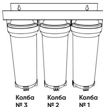
2. Обратите внимание, при установке в колбу картриджи должны оснащаться уплотнительными кольцами. Установка колец происходит в верхней и нижней части картриджа.
