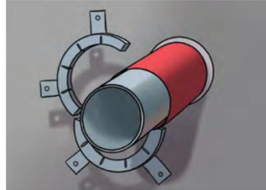
■ Пометьте точки крепления и просверлите отверстия
