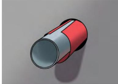
■ Герметично заделайте зазор для недопущения выхода дымов газов
