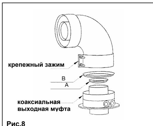
Если выход дымохода расположен снаружи, воздуховод должен выступать из стены не менее чем на 18 мм с тем, чтобы на него герметично установить алюминиевую погодную насадку во избежание попадания воды.
