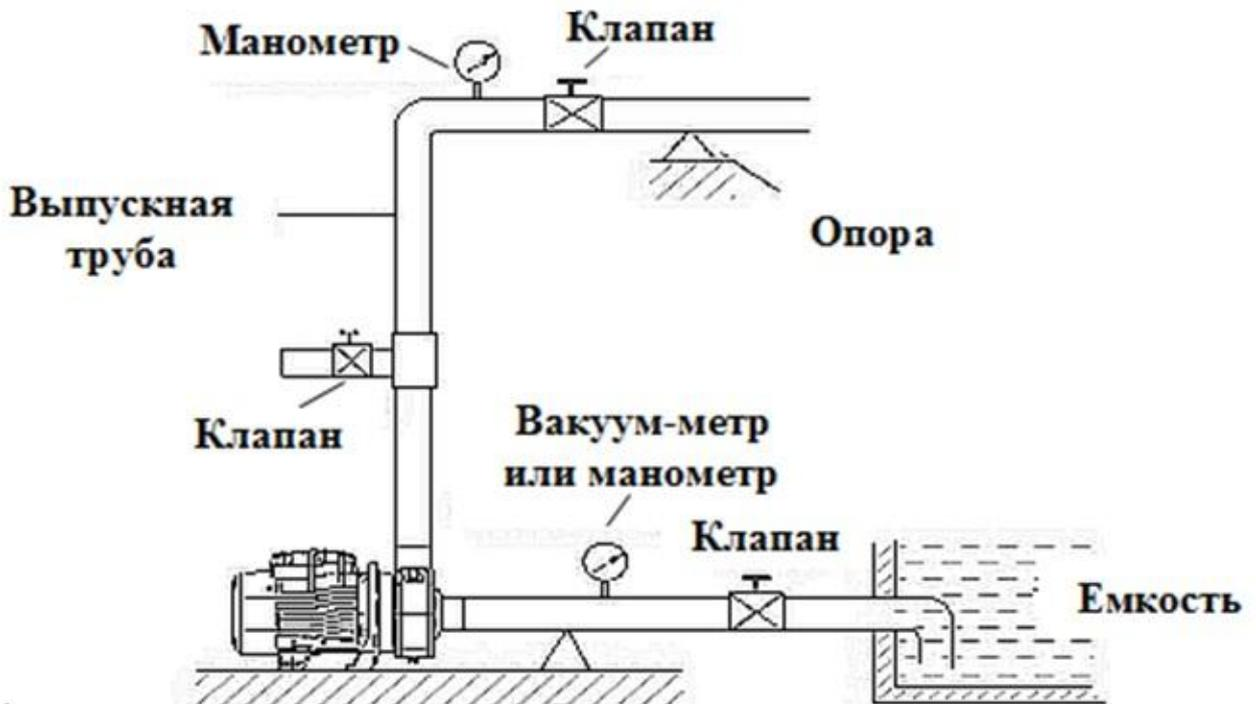
8. Трубопроводы должны обеспечивать полную герметичность от всасывания воздуха и протечек воды. В противном случае насос не сможет соответствовать заявленным требованиям по производительности и напору.
